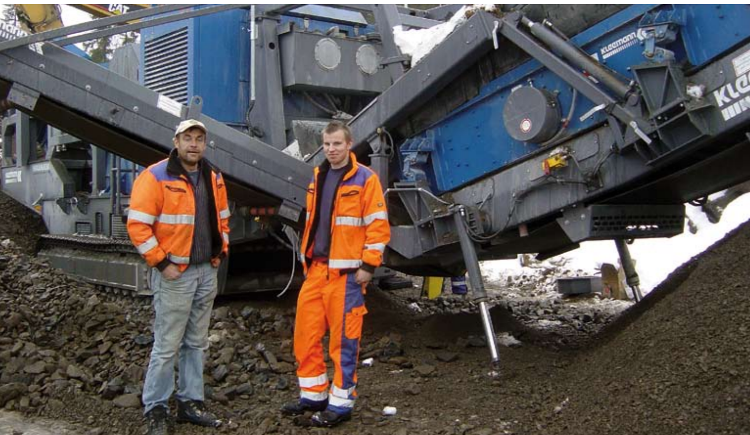
Knut Sørlundsengen og maskinoperatør Erik Rindal viser ett av bolagets andra nyförvärv, grovkrossen från Kleemann MCZ 110 med hängsikt.
