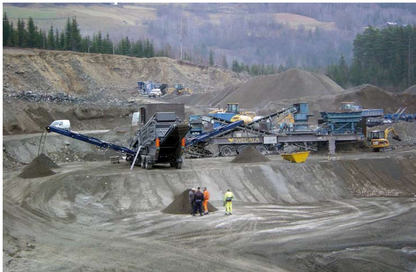
Den första S 1403 på plats i Øyer strax norr om Lillehammer i Norge. Hos Sørlandsengen Grus AS siktar den sandnings sand, ett 0-22 efter en Svedala H4000 Roadmaster, som delas upp i 0-2, 2-6, 6-16 och 16+.
