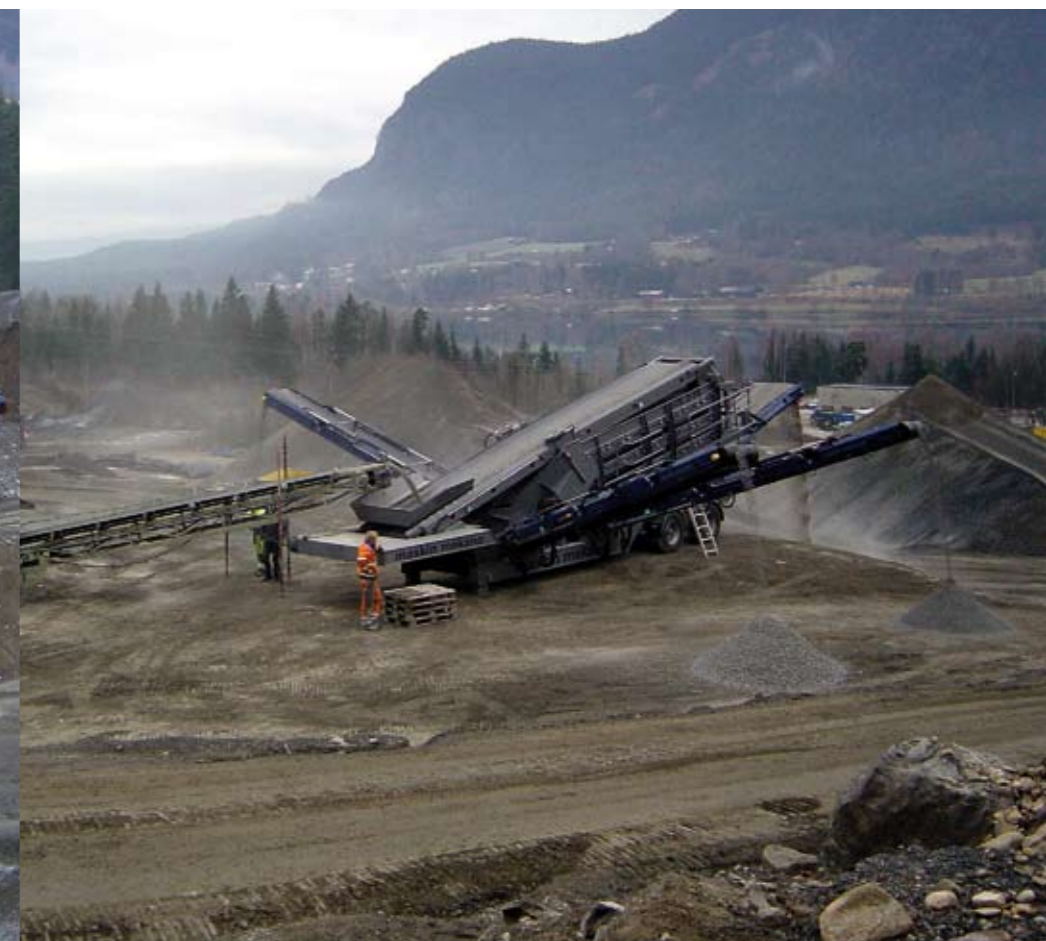
Den första S 1403 på plats i Øyer strax norr om Lillehammer i Norge. Hos Sørlandsengen Grus AS siktar den sandnings sand, ett 0-22 efter en Svedala H4000 Roadmaster, som delas upp i 0-2, 2-6, 6-16 och 16+.
